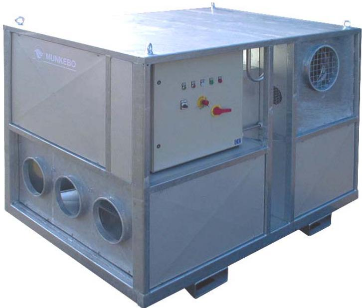
ZAM avfukterene fungerer etter Recusorbprinsippet: Strømmen av regenereringsluft passerer to ganger gjennom rotoren; først gjennom rensesekturen og deretter gjennom regenereringssekturen. På den måten blir regenereringsluften forvarmet før den når varmebatteriet, hvilket sparer opptil 25% regenereringsenergi sammenlignet med absorpsjonsavfuktere uten varmegjenvinning.
