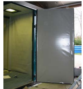
Innvendig kles kabinen med lys polyesterduk for beskyttelse mot rikosjetterende blåsemiddel.
