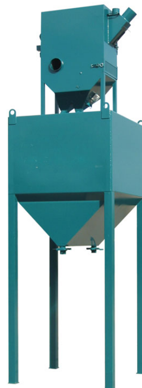
MB-ACU-2 trommelvindsikt montert på sandmagasin med utløp for 2 stk 200 l blåseapparater.
