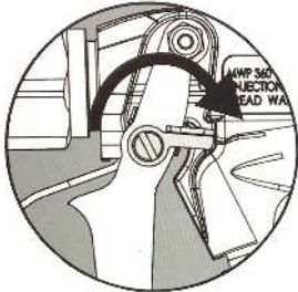
15a. HT sprøytepistol. Avtrekkersikring på.
