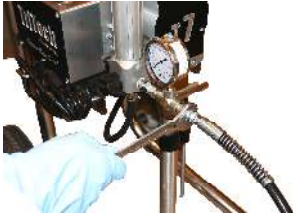
11. Materialutløp og trykkmanometer. Tilkobling av 13. HT malerslange.
