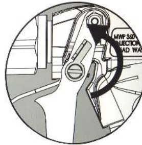
15b. HT sprøytepistol. Avtrekkersikring av.
