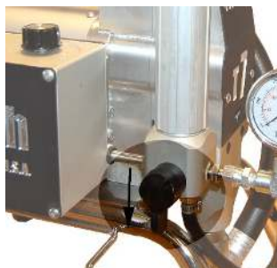
3a. Hovedventil åpen (peker ned/vertikalt). Innstilling for sirkulering, skylling og trykkavlastning.
