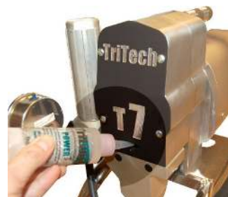
9. Smørekopp / påfyllingspunkt for TriLube (TSL) smøreolje.
