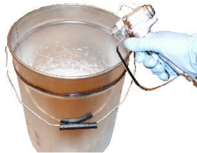
15c. Hold sprøytepistolen (dyse og holder demontert) med avtrekkerbøylene i kontakt med kanten på et metallspann. Trykk inn avtrekkeren.
