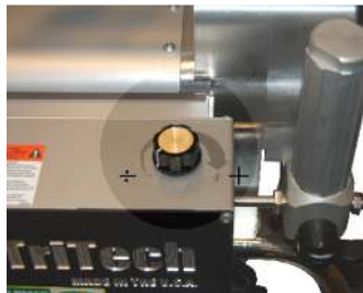
2. Trykksregulator. Mot klokken (÷) reduserer trykket. Med klokken (+) øker trykket.
