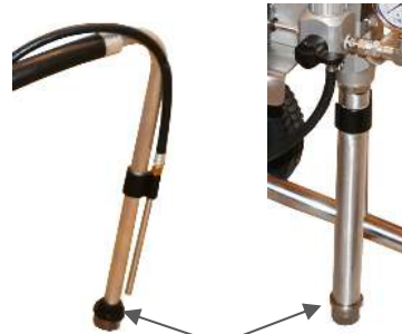
8. Inntakssil. Sjekk for blokkeringer.
