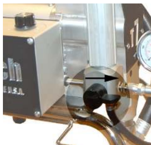
3b. Hovedventil lukket (peker fremover / horisontalt). Sprøyteinntilting.
